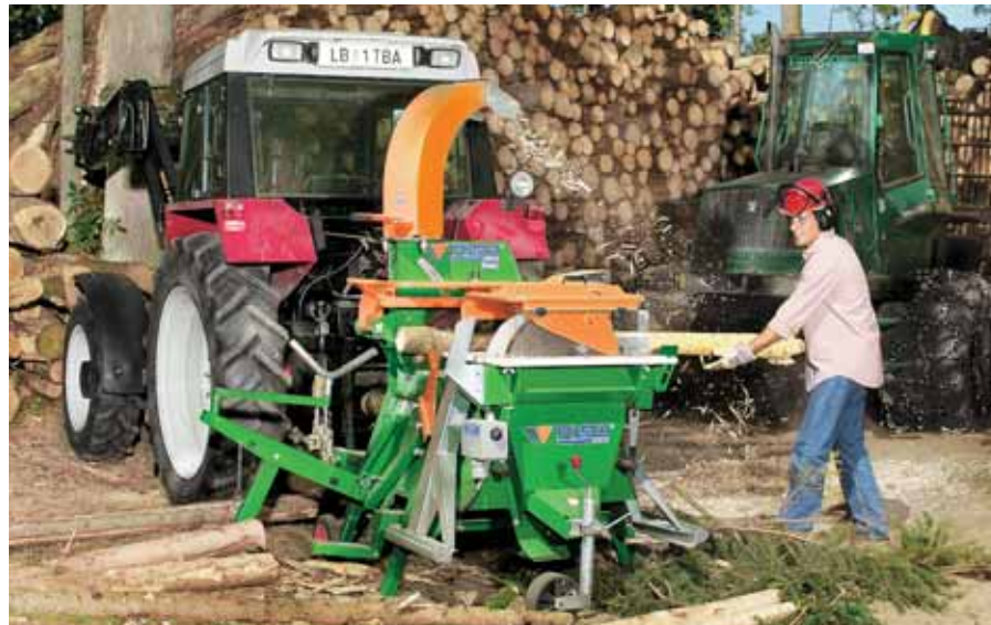
Schälprofi s ugradnjom kružne pile kao posebnom opremom
