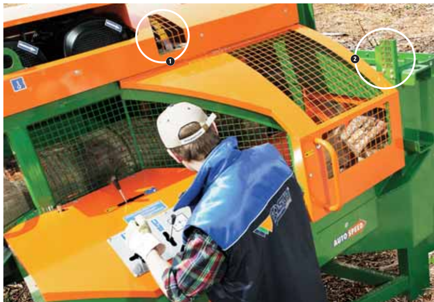
1 Dvostruka hvataljka je opremljena s pokazivačem l-drva. Tako se nož za cijepanje može idealno podesiti prema drvu koje se cijepa. 2
