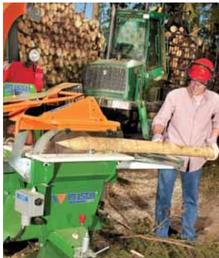
Schälprofi s ugradnjom kružne pile kao posebnom opremom
