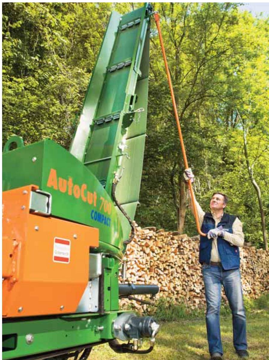
Jednostavno blokiranje transportne trake za transport
