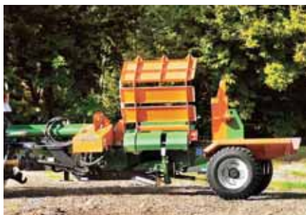
Lako transportirati: SplitMaster 30 s uzdužno povučenom traktorskom šasijom
