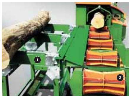
Dovod drva se radi preko poprečnog transportera 1 s lančanim pogonom i može se pozicionirati na obje strane stroja. 2 Uzdužni transport se radi pomoću pogona valjcima.
