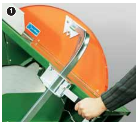
Zaštitni poklopac podesiv prema visini bez alata.
