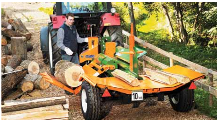
Lako transportirati: SplitMaster 30 s uzdužno povučenom traktorskom šasijom
