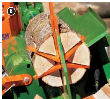
Varijante noža za cijepanje podesivog prema visini.
