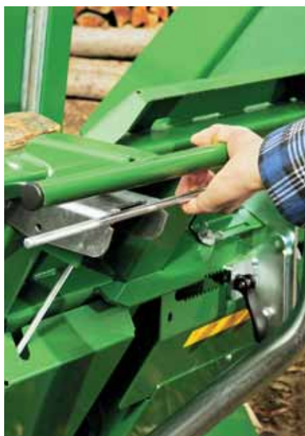
CutMaster 700 Comfort s hidraulički upravljanom klackalicom
