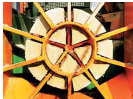
Prstenasti nož za cijepanje cijepa do 15 cjepanica
