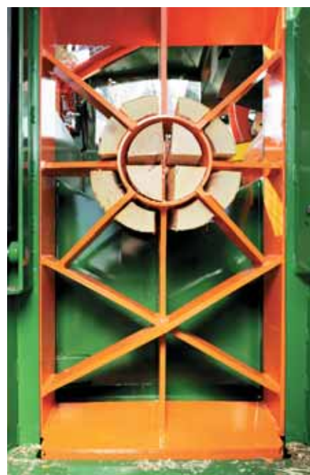
Specijalna izvedba: hidraulično podesivi nož za cijepanje za 2, 6 ili 12 cjepanica ovisno o podešavanju (dodatna oprema)
