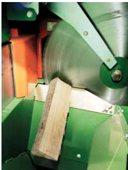
Automatsko fiksiranje drva skrbi za siguran rez
