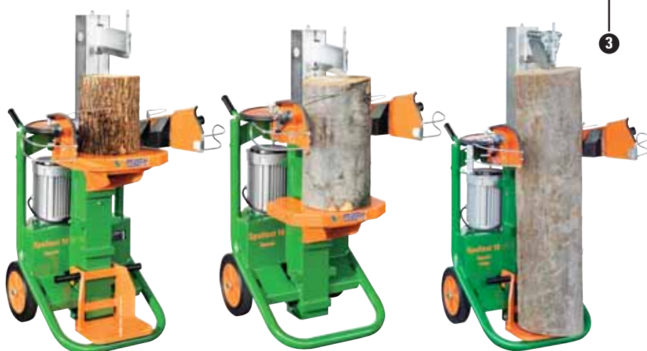
Pričvrсни stol za cijepanje kod posebne izvedbe: Time se mogu cijepati dužine drva od 100 cm, 82 cm (donja pozicija pričvršćivanja) odn. 55 cm (gornja pozicija pričvršćivanja). Opcionalno dostupno: podna ploča za max. dužinu drva od 130 cm.
