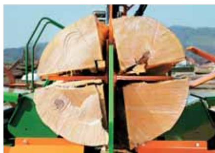
Hidraulično podesivi nož za cijepanje cijepa drvo snažno.
