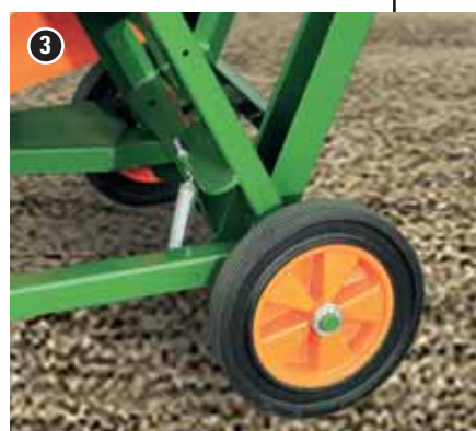
Veliki kotači s punom gumom s 300 mm | za udoban transport.
