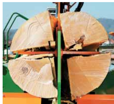
Hidraulično podesivi nož za cijepanje cijepa drvo snažno.
