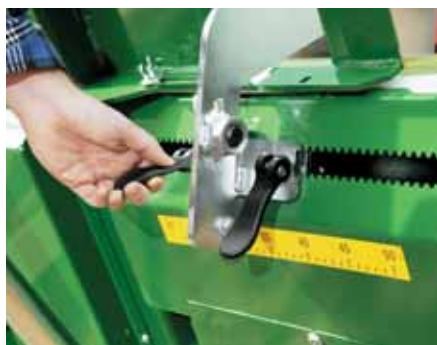
Mehanički graničnik s laganim rukovanjem za gotovo bezstupnjevitom pomicanjem dužine reza
