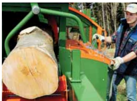
Manipulator drva dovodi drvo prilikom uvlačenja u idealnu poziciju.
