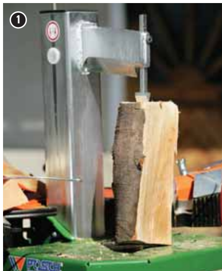
Šiljak za pridržavanje drva omogućuje lako držanje tankog i ukoso otpiljenog drva.
