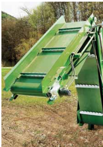
Pregibna transportna traka udobno se može preklopiti prema stroju (opcija).
