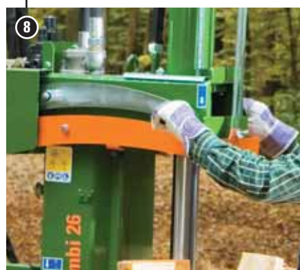
GS-provjereni dvoručni sigurnosni upravljač: Tako ruke ne dolaze u doticaj s nožem za cijepanje. Pritisnu li se obje poluge prema dolje, nož za cijepanje se kreće prema dolje.
