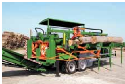
Spaltfix K-550 s poprečnim transporterom i transportnom trakom (dodatna oprema)
