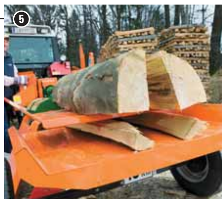
Varijante noža za cijepanje podesivog prema visini.
