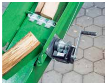
Vitlo transportne trake za teleskopiranje u radnu poziciju
