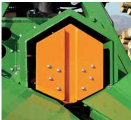
Utiskivač pritišće drvo s više od 40/55 t na nož za cijepanje.
