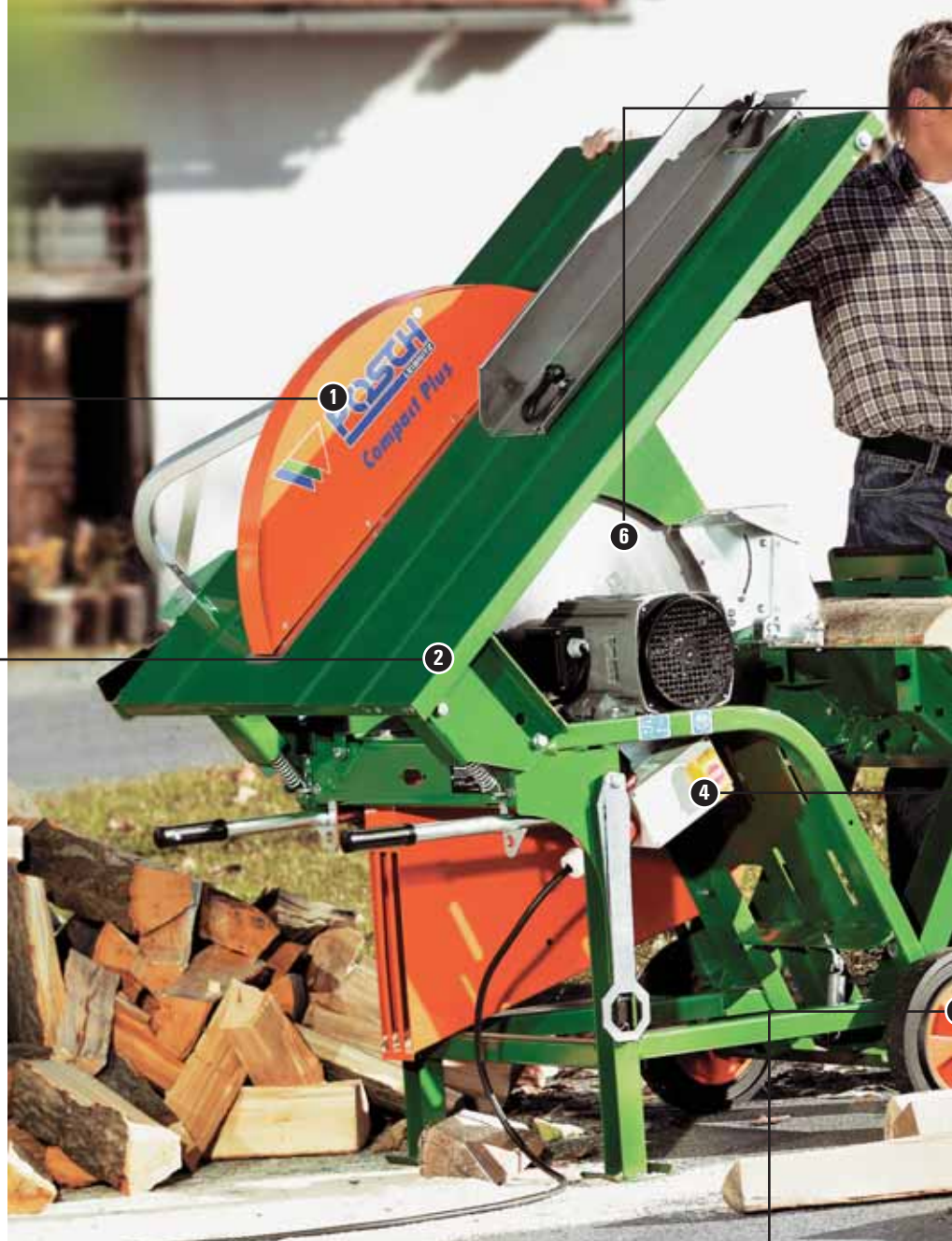
Zaštitni poklopac podesiv prema visini bez alata.
