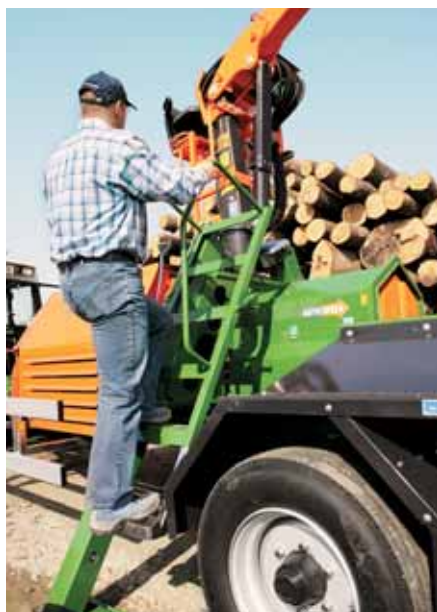
Preko pomoći za penjanje do radnog mjesta s ručnim upravljanjem za kran i nožne papučice za upravljanje cijepanjem.
