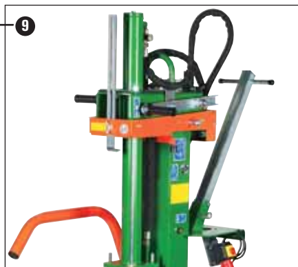
Spuštajući cilindar za jednostavan transport i skladištenje uz uštedu prosotra.
